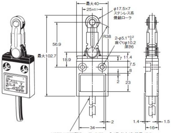
VCTF、VCTF耐油コード: 0.75mm<sup>2</sup> 4芯 仕上がり外径φ7.6 SJT(0): 0.83mm<sup>2</sup> 4芯 仕上がり外径φ8.6
