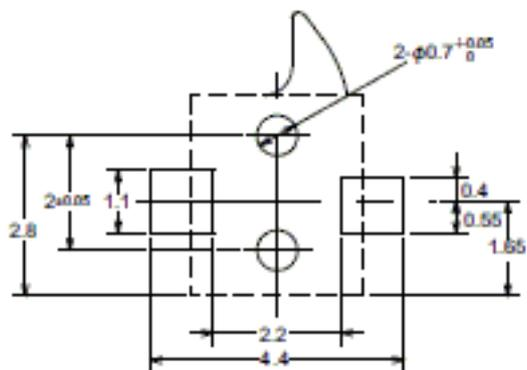
プリント基板取り付け穴およびランド寸法図(参考)
