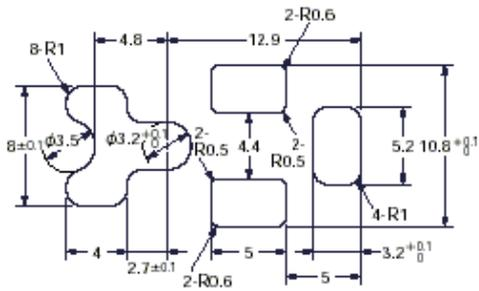
取り付け板厚  $t=1.2\text{mm}$  の場合
