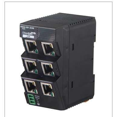
EtherCAT分岐スリーブ GX-JC06
