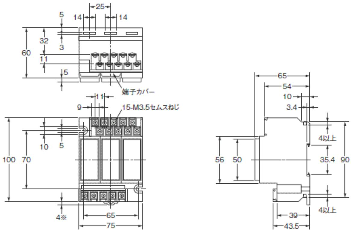
注. DINレール取り付けスライダを挿入した場合の寸法です。
