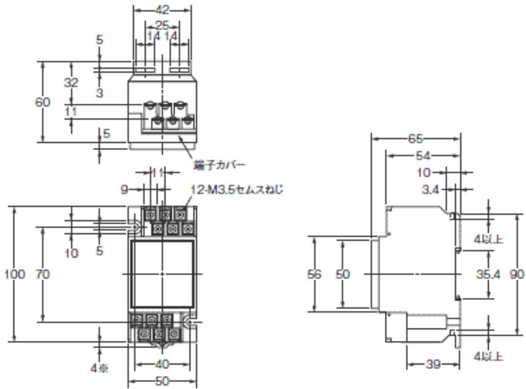
注 DINレール取り付けスライダを挿入した場合の寸法です。
