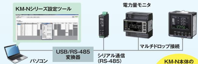
USB/RS-485変換器を用いて、パソコンとマルチドロップ
