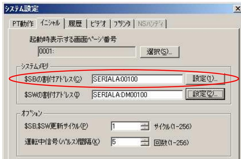
注：\$ S B に対しては、デフォルトの内部メモリ \$ B を割り付けて変換されます。CX-Designer において、必ず \$ S B に対して P L C アドレスを割り付けるか、\$ S B、\$ S W とともに内部メモリに割り付けてください。この設定をしないと、P T 本体に画面データを転送しても、正常に動作しない可能性があります。
