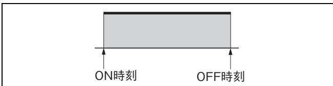
設定されたON/OFF時刻に従って出力を制御するタイムスイッチの動きを、タイマ動作といいます。
