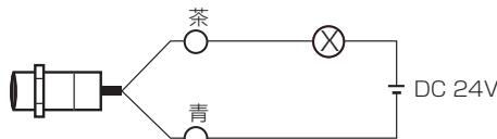
注. 直流2線式には残留電圧が3Vありますので、リレーの動作電圧を確認のうえでご使用ください。
