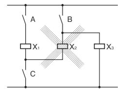
下図は上図を修正した正しい回路例です。なお、直流回路においては、ダイオードによる回り込み防止が可能です。
