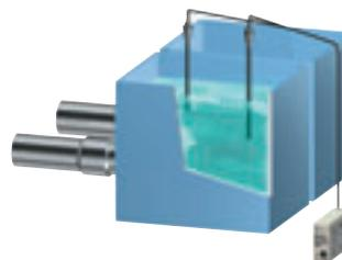
注: 防爆エリアでひとつの水槽に形K7Lを2個以上ご使用になる場合は、必ず水槽をアース接地してください。
