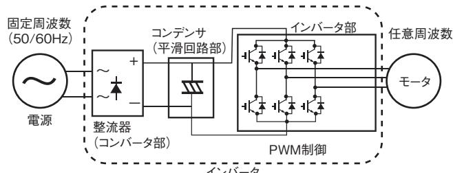
インバータの出力電圧はパルス状です。このパルスがモータコイルで平滑されて、正弦波の電流が流れます。このため、汎用インバータの出力は、一般的にモータ以外には使用できません。
