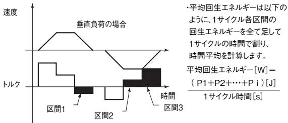
注1. 速度は正回転方向を正、トルクは正回転方向のトルクを正で示しています。
