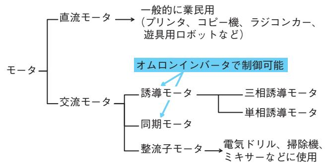
誘導モータは、比較的安価で簡単な速度制御ができるので、多くのアプリケーションに使用されています。交流電源をつなぐだけで回転するため、設置も非常に簡単です。一般的には、後方に冷却ファンが取り付けてあり、モータ自身の放熱を促進しています。
