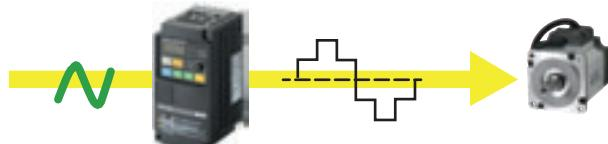
周波数・電圧を自由に設定できる制御をPWM(パルス幅変調)制御といいます。インバータは、交流の入力電源を一度直流電源に変換し、その変換した直流電源からPWM制御を使って、再度交流電源を作っています。このとき、インバータはパルス状の電圧を出力しますが、このパルスがモータコイルで平滑され、正弦波の電流がモータに流れることでモータの回転数やトルクを制御しています。
