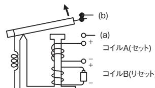
コイルAと逆方向に巻かれたコイルBに電流を流すと半硬質磁性材料の残留磁束を減少させ、吸引力が弱くなり、復帰ばねの力が打ち勝って鉄片は復帰し、休止状態となります。鉄心が復帰すると半硬質磁性材料の残留磁束はほとんどゼロになります。
