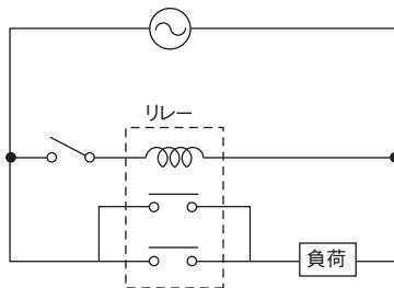
**?** 微小負荷開閉に適したツイン接点のリレーの形式を教えてください。
