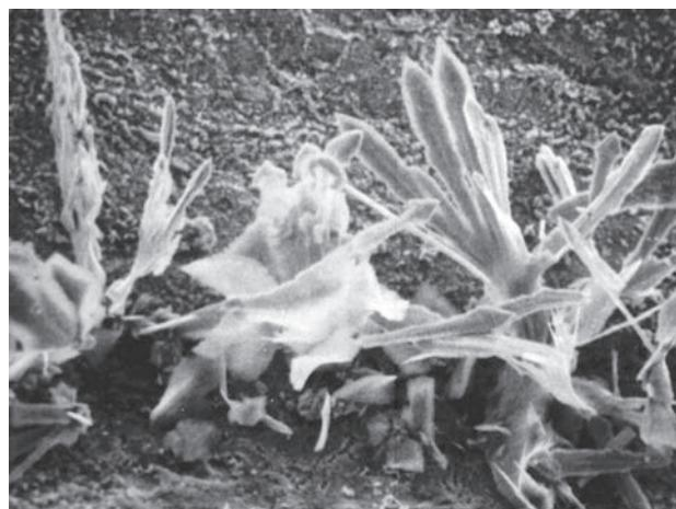
当社の一般リレーは、溶融メッキや特殊亜鉛メッキの採用により、これらのウィスカ対策済みですが、部品設計、プリント基板やパターン設計時には、亜鉛や錫メッキ部品と電気回路の絶縁距離を十分とするなどの配慮をお願いします。
