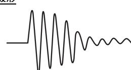
ACソレノイド投入電流波形
