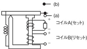
コイルAに電流が流れると電磁石(半硬質製材料)が磁化され、鉄片が鉄心に吸引される。
