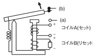
コイルAと逆方向に巻かれたコイルBに電流を流すと半硬質磁性材料の残留磁束を減少させ、吸引力が弱くなり、復帰ばねの力が打ち勝って鉄片は復帰し、休止状態となります。鉄心が復帰すると半硬質磁性材料の残留磁束はほとんどゼロになります。
