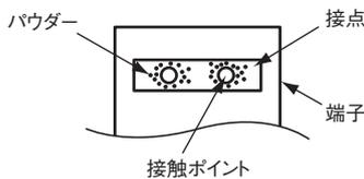
注. ある種の有機ガスの存在する雰囲気中で主として白金系の接点が開閉動作する場合に、接点のすり動作によって生じ、接点障害の一原因となる。
