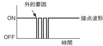
コイルをオンした時の各部の応答とバウンスの関係を下図に示す。
