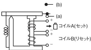
この状態でコイルAの電流を取り除いても半硬質磁性材料(永久磁石に近い特性を持つ材料)の残留磁束により鉄片は鉄心に吸着した状態を維持し続けます。
