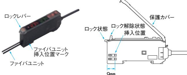
注. 同軸タイプなどファイバユニットの片方に投光側表示がある場合は、投光側表示のある素線を投光部に挿入してください。なお、投光側表示の有無は各ファイバユニットの外形図をご参照ください。
