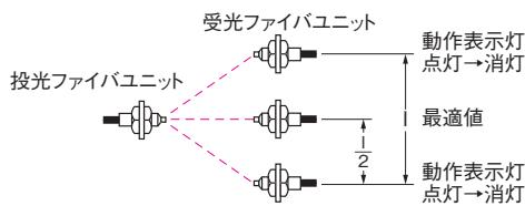
**光軸**：投光ファイバユニットの場合、検出面の中心と投光ビームの中心を結ぶ軸を光軸といいます。
