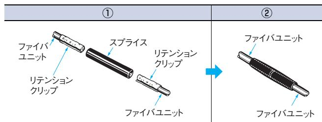
・装着時、おのののファイバユニットをできるだけ密着させてください。
