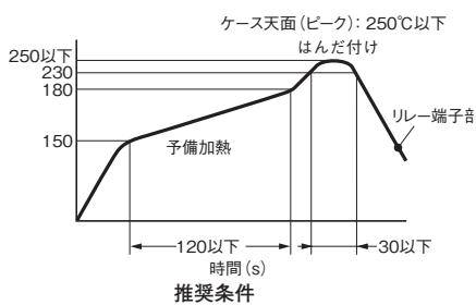
注：リレーをはんだ槽に浸漬しないでください。樹脂変形などによる動作不良の原因となります。
