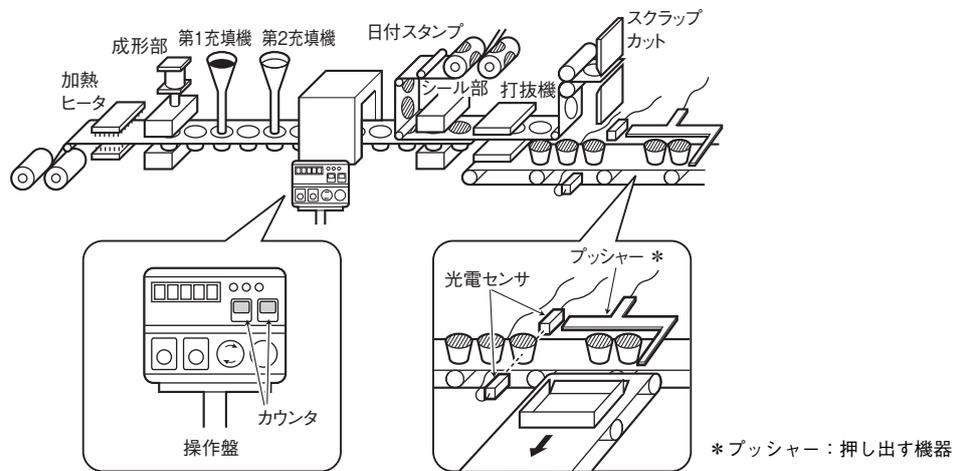
ここで、＜プリン生産ライン＞の箱詰め工程を例に、プリセットカウンタの動作について、入力→制御→出力の信号の流れで説明します。
