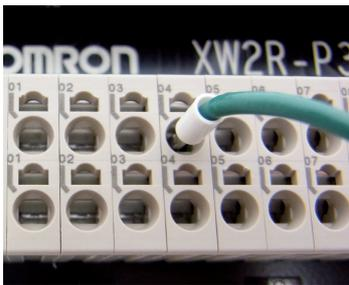
プッシュイン端子台は、電線を差し込んだ際に、クランプバネの圧力により電線を固定します。電線は、①棒端子、②単線、③より線の3種類が使用可能です。
