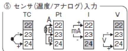
TC: 熱電対、非接触温度センサ
