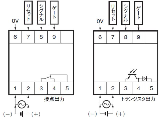
H5CX-AS□-N の、出力トランジスタのコレクタに接続してあるダイオードは、誘導負荷使用時の逆起電圧吸収用としてご利用ください。
