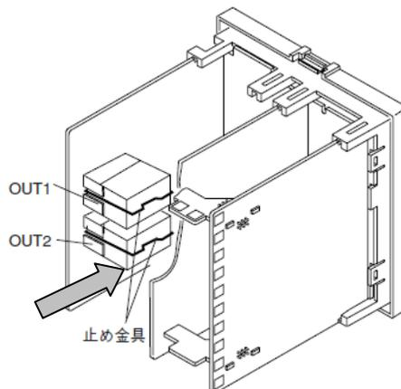
止め金具を外し、右図のようにドライバーの先でユニットを押し上げると本体から取り外すことができます。
