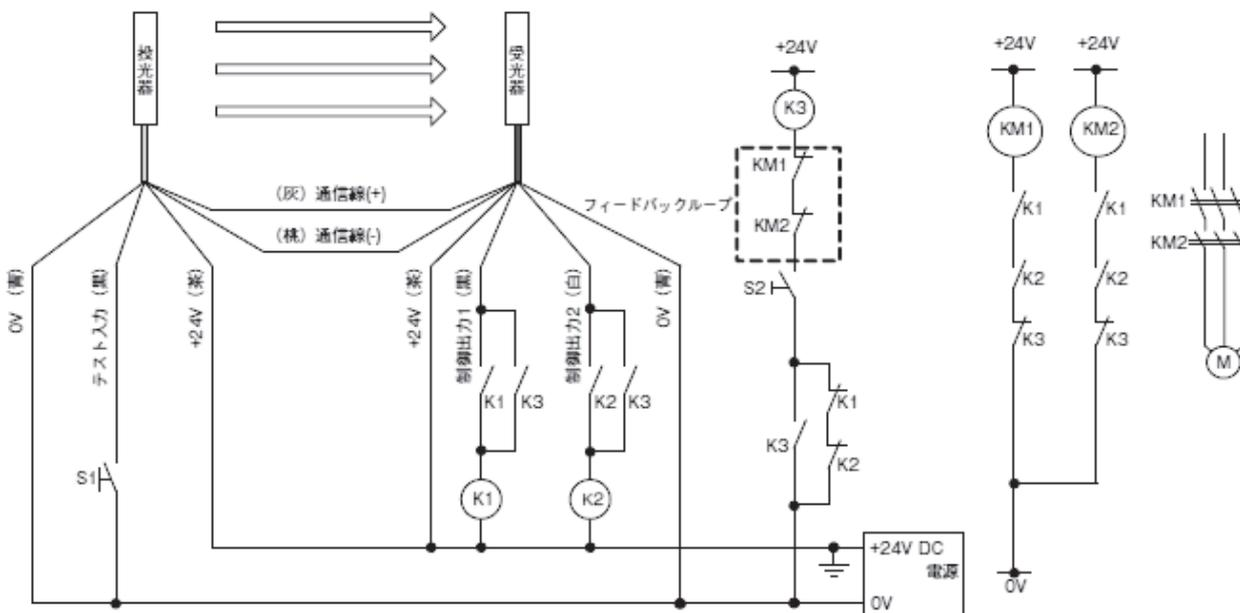
S1 : 外部テスト/ロックアウトリセットスイッチ (スイッチが不要な場合は、24Vに接続)
