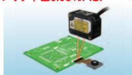
計測レンジ全てを必要としないアプリ例 薄型コネクタアセンブリ高さ計測
