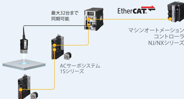
EtherCATの周期的な通信に同期して、センサが自動で測定を開始します。
