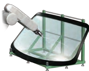
ガラス面の曲率測定
