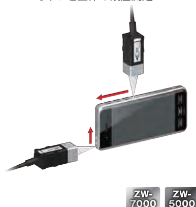
ボタンと筐体の段差測定
