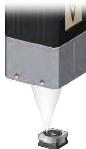
カメラモジュールのストローク測定
