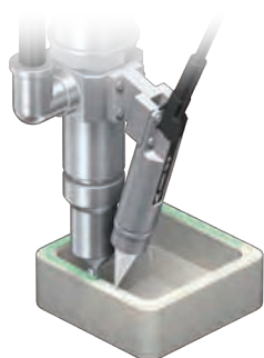
樹脂塗布時のノズルGAP検査
