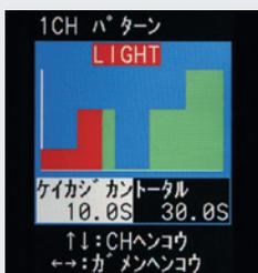
一定照射だけでなくパルス照射などのパターン照射も可能。樹脂の収縮を抑えます。
