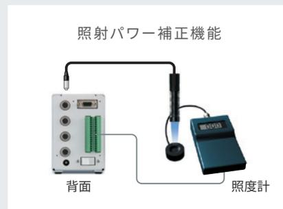
照度計の出力をもとに、照射パワーを補正できるパワーチューニング機能を搭載。始業点検時に簡単にパワー補正が行えます。
