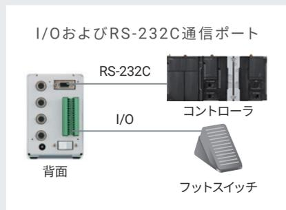
照射のON/OFF、照射パターン切り替え、各種アラームなどをI/Oポート、もしくはRS-232C通信により、外部から制御できます。
