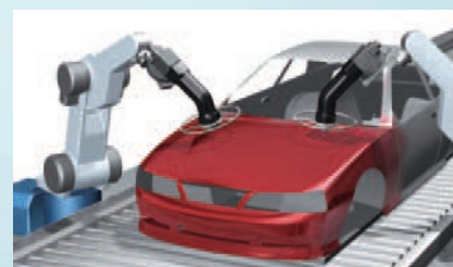
自動車塗装工程のブツの発生源の監視(粗粒子)
