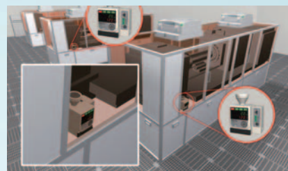
2次電池製造装置の発塵管理(粗粒子)
