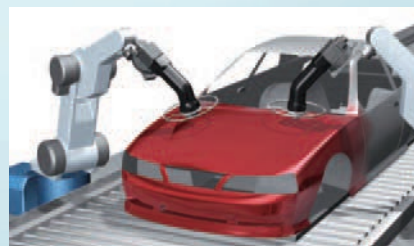
自動車塗装工程のブツの発塵源の監視(粗粒子)
