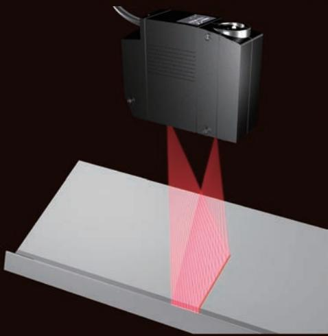
計測対象物の2直線上の「交点座標」「交点角度」を計測する機能を搭載。溶接対象物に対する、溶接トーチのならい制御などに活用できます。
