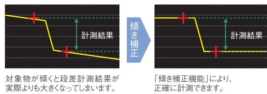
「傾き補正機能」により、正確に計測できます。
