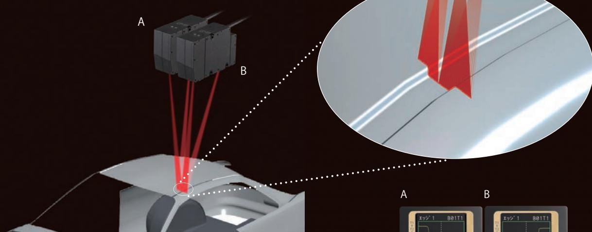
2台のセンサコントローラを連結し、センサヘッド2台の同期計測を行うことで最大140mmまで計測範囲を拡大。連結方式の採用で、用途に応じた最適なソリューションをご提供します。
