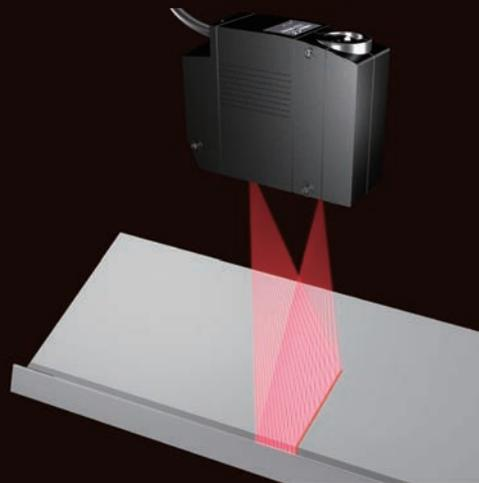
計測対象物のもつ2直線上の「交点座標」・「交点角度」を計測する機能を搭載。溶接対象物に対する、溶接トーチのなれない制御などに活用できます。
