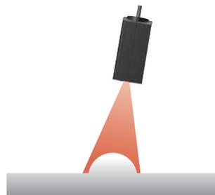
※傾きが大きいと計測誤差が生じることがありますので、実際の環境で計測精度を確認の上、使用してください。
