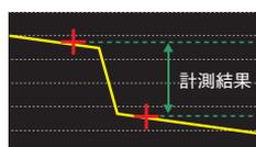
対象物が傾くと段差計測結果が実際よりも大きくなってしまいます。
