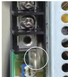
**従来** 振動でねじが脱落する…
