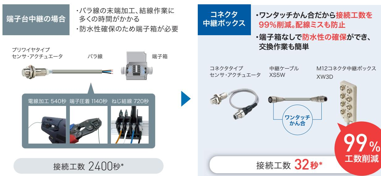
\*3線式コード引き出しタイプセンサ8台を端子台に接続する場合と、コネクタ中継タイプセンサ8台をコネクタ中継ボックスに接続する場合の比較。当社調べの参考値。
