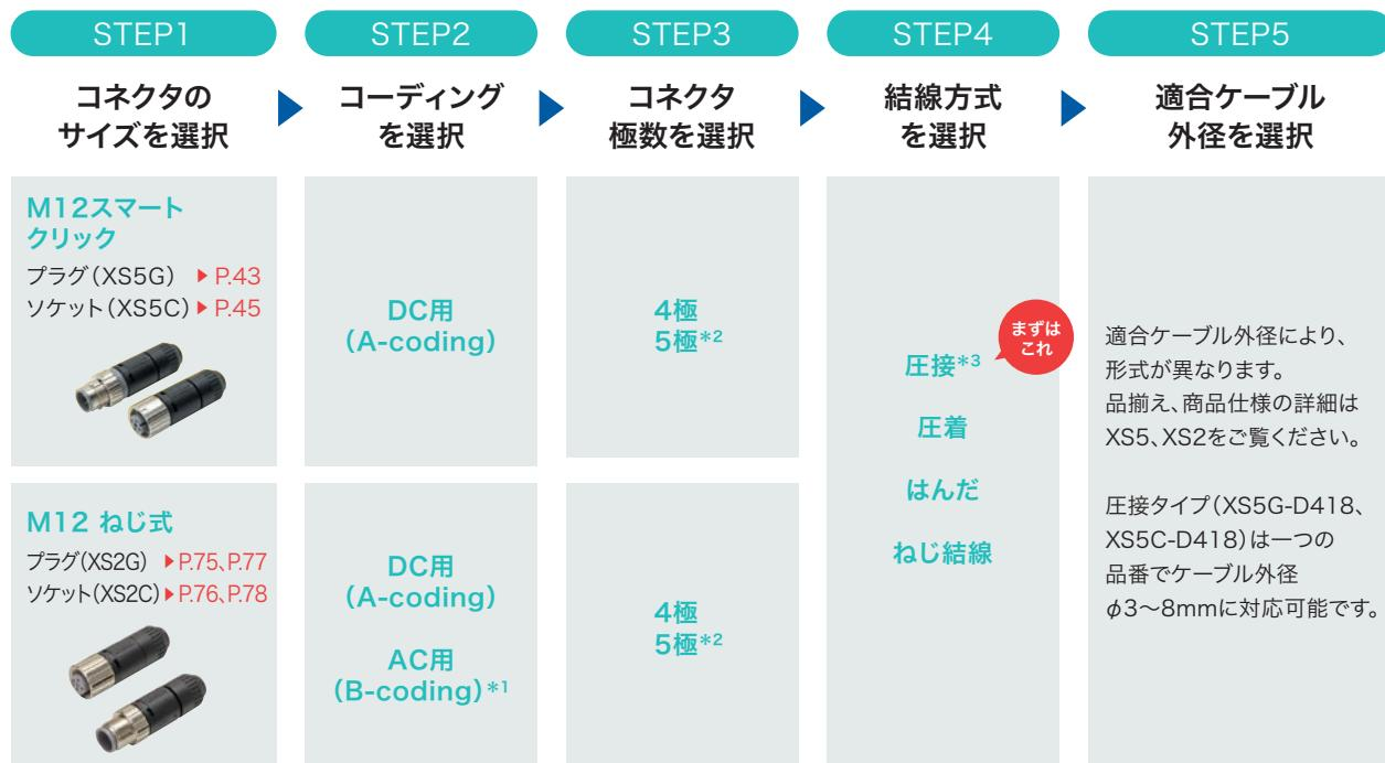
\*1. AC用は圧着／はんだタイプのみ \*2. 5極はねじ結線タイプのみ \*3. 圧接タイプはXS5(スマートクリック)のみ
