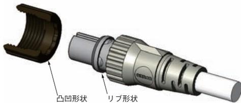
上記の構造により、45°単位で固定具の凹凸とハウジングのリブが干渉し、かん合時の緩み防止として働きます。
