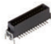
プラグ ストレート 端子部 SMTタイプ、ホールダウン部 THRタイプ
