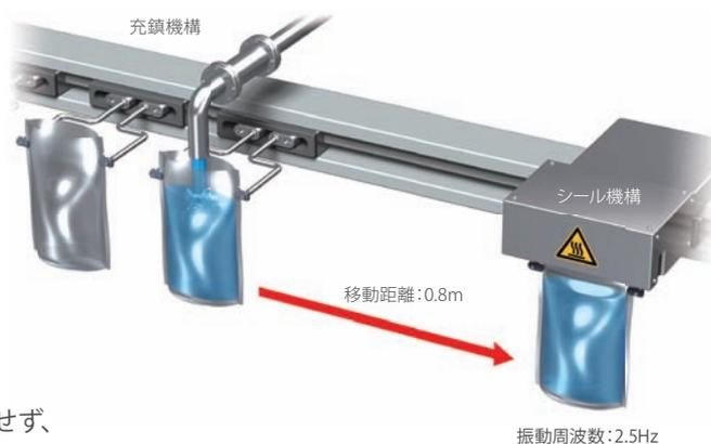
搬送アプリケーション 液体の充填後、シール機構の位置まで搬送され、ヒートシールにより封止される。
