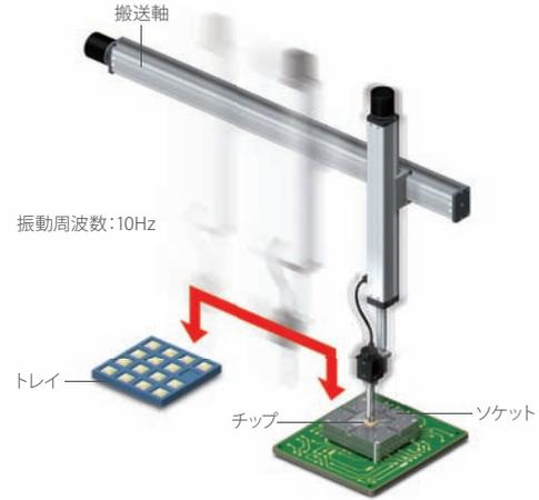
搬送アプリケーション XZ軸の搬送装置で、チップをトレイからソケットへ移載する。
