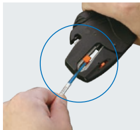
電線被覆を剥く
