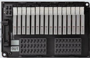
リレーターミナル
