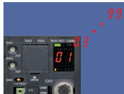
7種類の交信状態モードを見える化し、上位機器不要でアンプ・コントローラの前面で簡易診断できます。現場オペレータの確認が容易になるのはもちろん、取付調整・立上げ・メンテナンスの工数を大幅に削減します。
