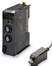
オムロンのマシンオートメーションコントローラNJ/NX/NYシリーズ、PLC CS/CJシリーズに直接RFIDシステムを接続できる通信ユニットです。PLCのメモリエリアにパラメータをセットするだけでデータの読書きが簡単にできます。シリアル通信に比べ、シンプルな機器構成で高速にデータを処理できます。また、ラダープログラムの機能部品ライブラリ (FB) を使ってより簡単に通信プログラムを作成できます。
