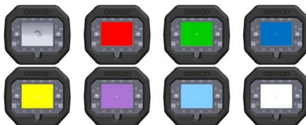
ドーム照明は、ダイレクトパーツマーキングの読取り最適化に別の次元を追加します。部品の表面色と反対の照明スペクトルを使用すると、部品の外観がより暗く表示されます。同一の照明スペクトルを使用すると、部品の外観がより明るく表示されます。
