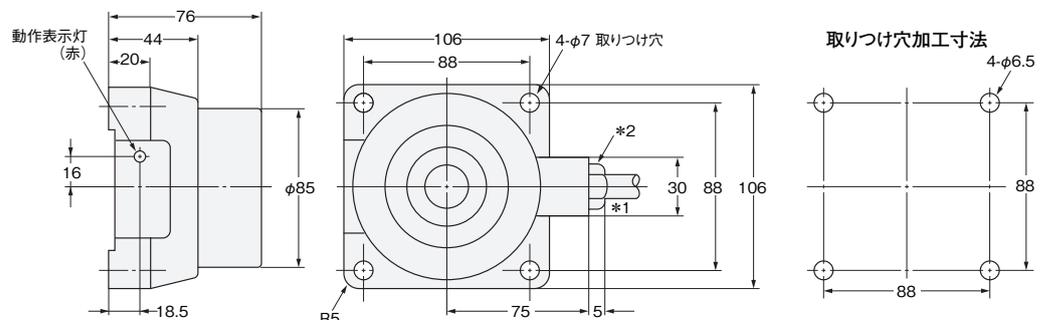
\*1. ビニルキャブタイヤコード：形TL-LP50：ビニル絶縁丸形コード φ9.4、3芯(導体断面積:0.75mm<sup>2</sup>、絶縁体径:φ2.8mm) 標準1m
