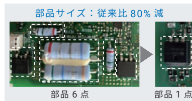
CP回路部の自動電流制御で 低発熱設計を実現
