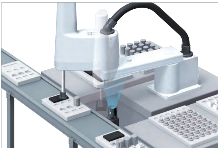
位置補正しながらPick&Place (高速アライメント)
