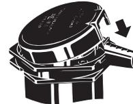
●水槽への電極保持器取り付け方法
