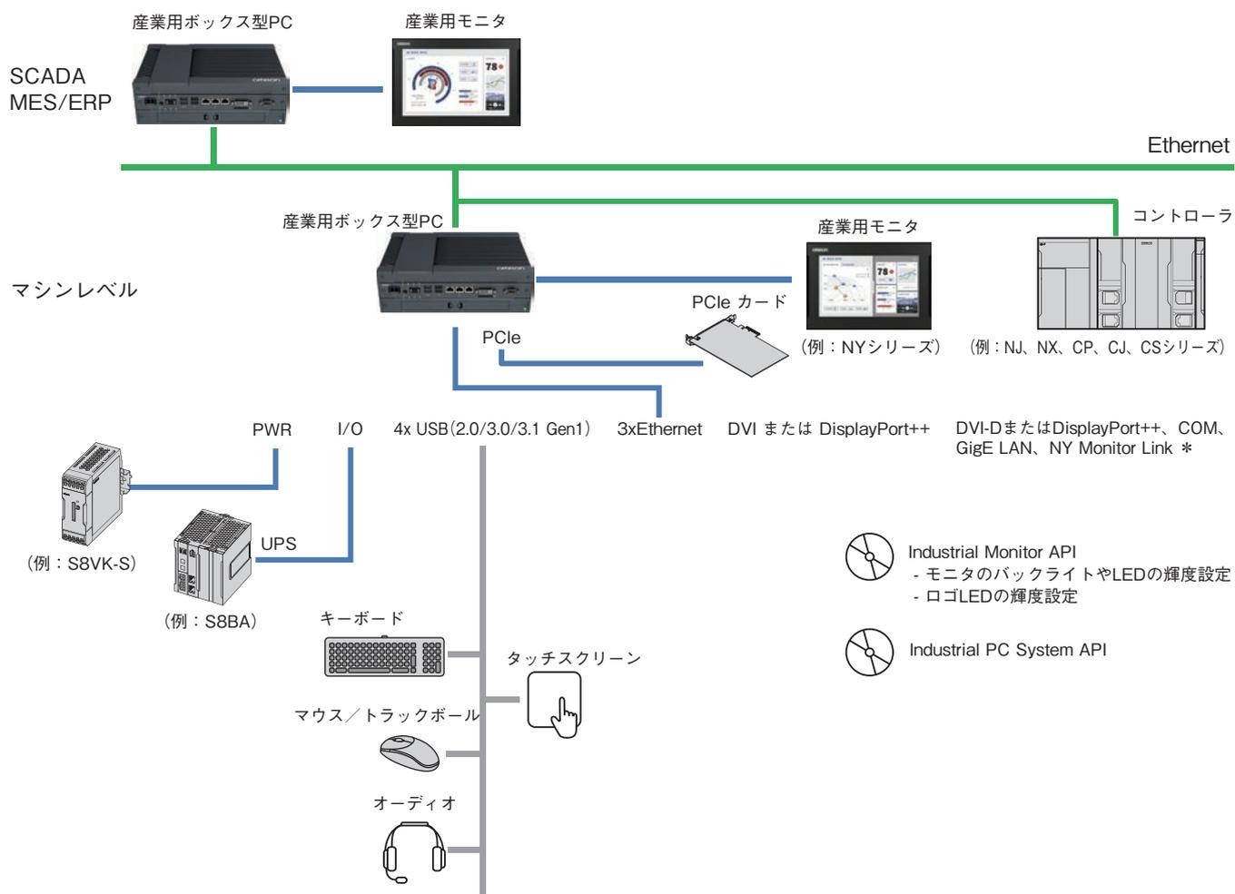
\*NY Monitor Link: 最長100mまでの汎用Ethernetケーブルでモニタを接続できます。
