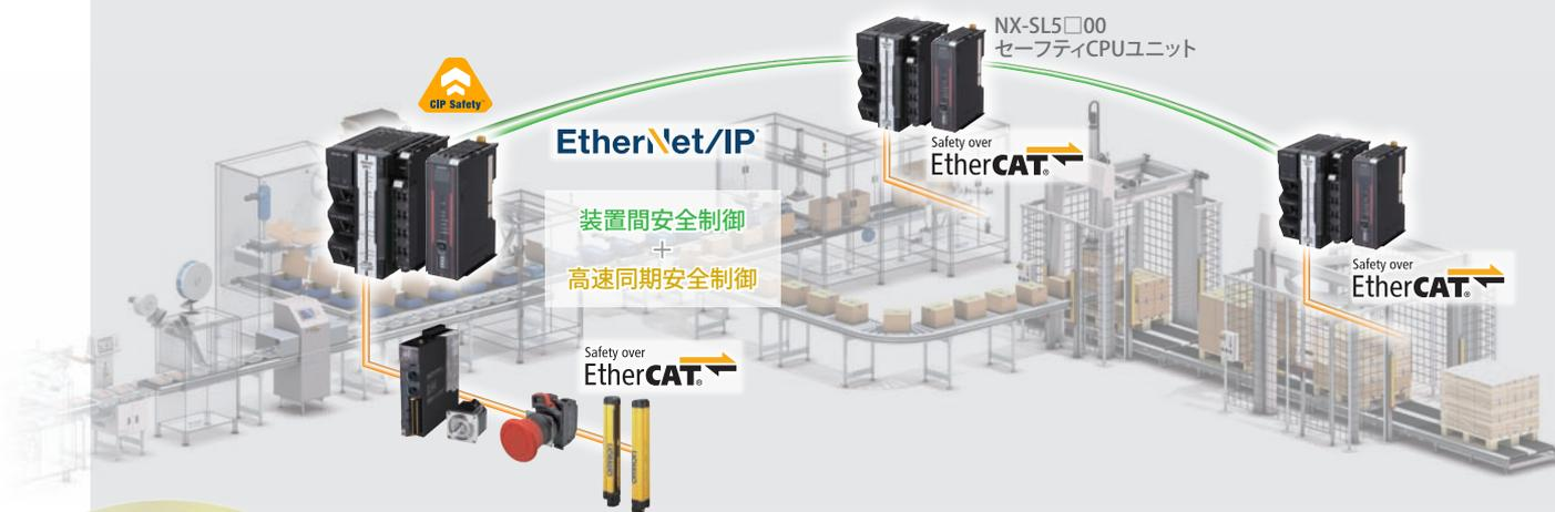
世界で初めて\*、ラインと装置の安全制御に最適な2つの異なるオープンネットワークを統合しました。ラインには、EtherNet/IP™で拡張性の高い安全制御が、装置内はEtherCAT®で高速、かつ冗長化に対応した信頼性の高い安全制御が可能。また、高速タクトが必要なラインでも装置制御と安全制御を同時に実現できます。これによりマシンの標準化ができ、柔軟なラインの構築が可能です。
