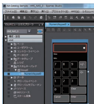
ユーザ専用キーパッドを作成 不要なキーを外したり、 ボタン押下で特殊な動きをカスタマイズが可能
