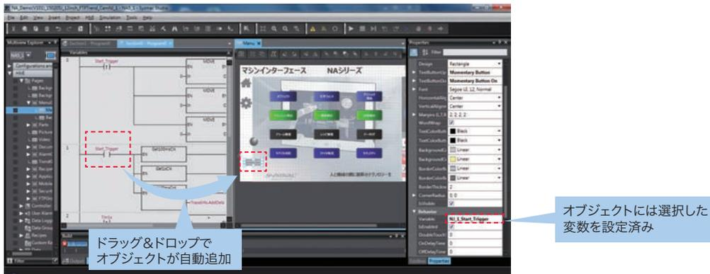
\*入力接点を指定した場合はボタン、出力接点の場合はランプを自動作成。
